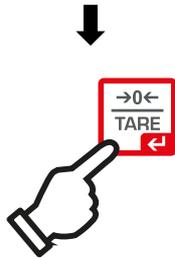
⇒ [ >0< | TARE ] drücken, um die Waage auf Null zu setzen
