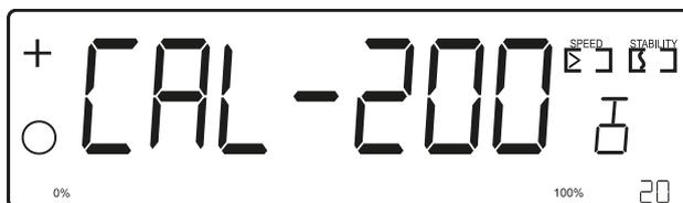
⇒ <CAL .. 100> oder <CAL .. 200> wird angezeigt (Modellabhängig)
